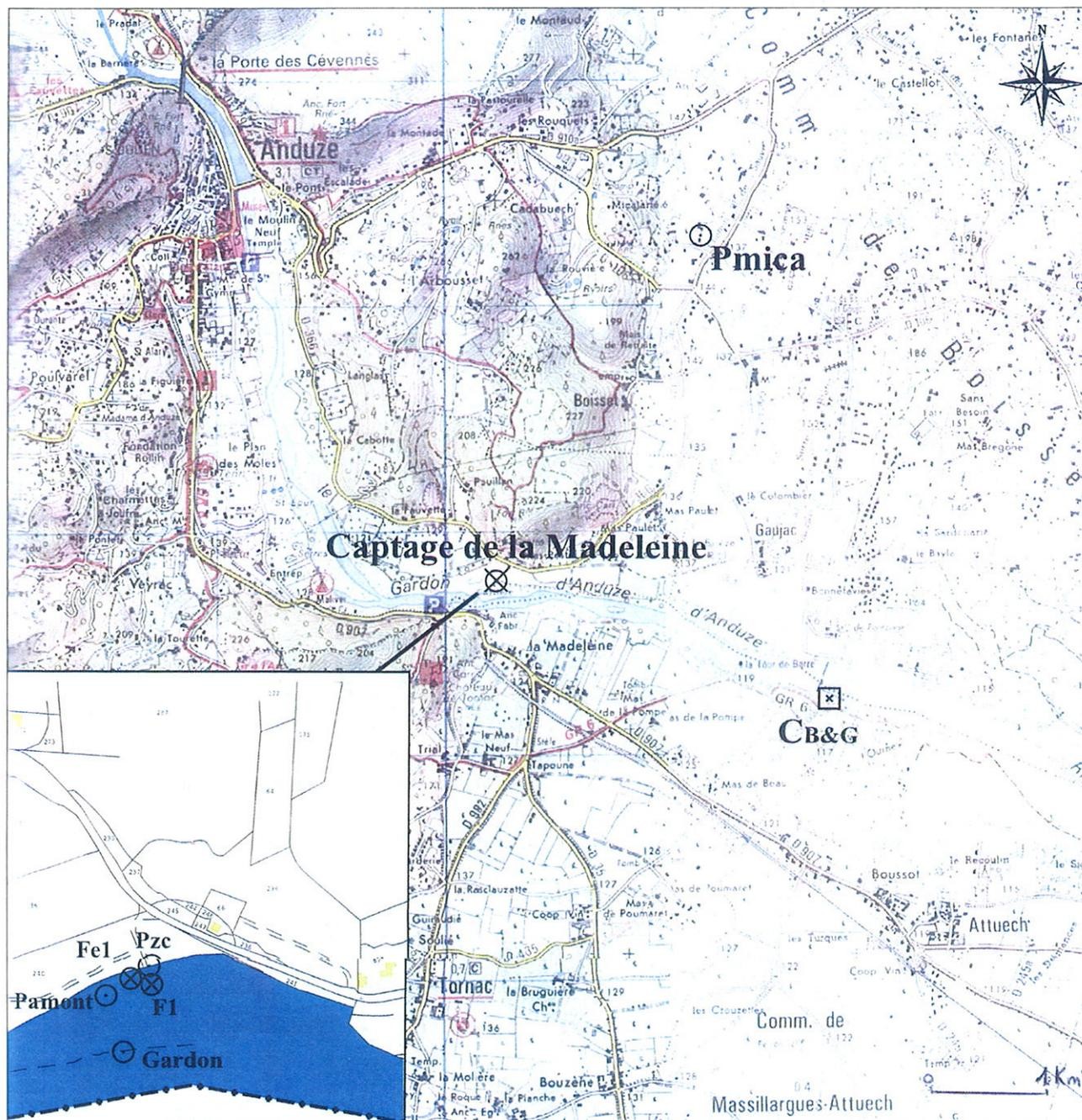
Figure 3 : localisation des forages Fe1 et F1 et des piézomètres
